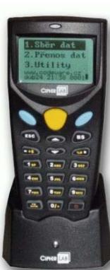
Systém sledování výroby může být doplněn libovolným počtem přenosných terminálů, pomocí kterých lze načítat data kdekoli a kdykoliv. Tyto terminály jsou také vybaveny snímačem čárových kódů. Typickým příkladem využití je provádění příjmu/výdeje zboží nebo inventury skladů. Čtečky mohou pracovat online přes wi-fi síť nebo jsou data ukládána ve vnitřní paměti a k jejich přenosu do PC dojde po uložení terminálu do stojánu ve kterém se nabíjí.
